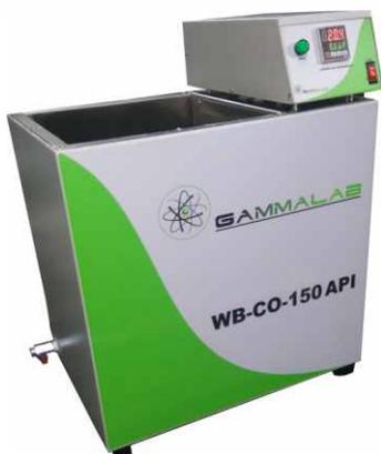
El baño WB-CO-150 API °C/°F, permite utilizar un volumen de 45 litros de aceite térmico (DOWTHERM) o agua como medio de calentamiento indirecto o de convección térmica para pruebas especializadas de API en crudos y livianos.
