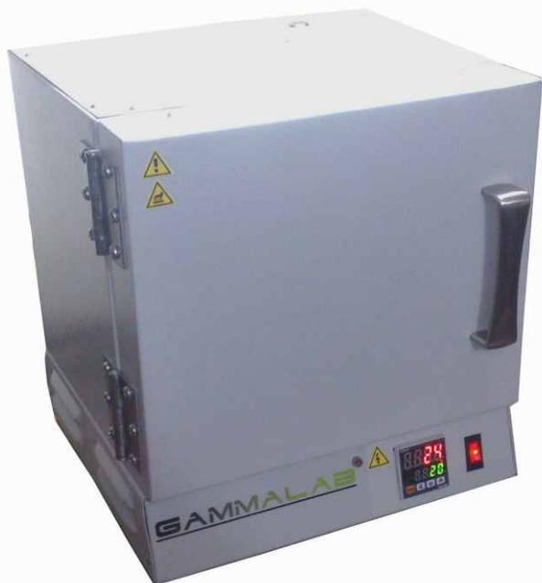
Las muflas digitales de laboratorio Gammalab están diseñados para procesos donde se requieren temperaturas hasta los 1100°C, utilizando calefactores de semiconductor tipo kanthal, un sistema de aislamiento de calor del tipo refractario liviano, que en conjunto con un robusto controlador, garantizan la calidad en procesos de carbonización, incineración y fundición.
