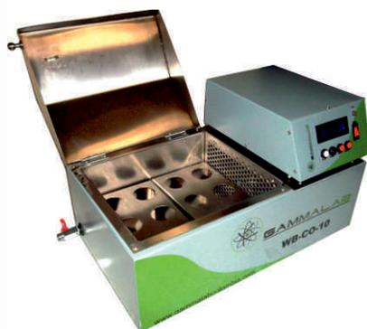
El baño WB-CO-10,20 °C/°F, permite utilizar un volumen de 10 a 20 litros de aceite térmico (DOWTHERM) o agua como medio de calentamiento indirecto o de convección térmica.
